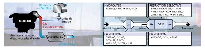
Un système à SCR utilise AdBlue® et un catalyseur monté sur le silencieux du véhicule pour réduire les NOx en vapeur d'eau et azote atmosphérique. Cette réaction a lieu dans le système d'échappement et est appelé "après-traitement". La SCR peut atteindre des taux de réduction des NOx de plus de 80%, permettant au moteur d'être ajusté pour une efficacité maximale. L'ajustement du moteur pour une efficacité maximale permet une économie estimée de carburant de 3 à 5%.
