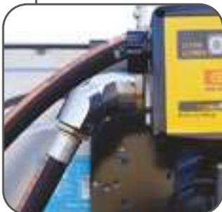
Raccord tournant en sortie de compteur
