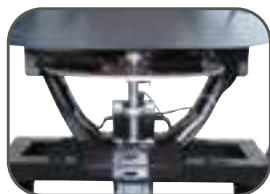
Disque et palettes en acier inoxydable
