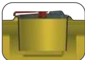
Trou d'homme avec couvercle monté sur charnière et manchette anti-vagues
