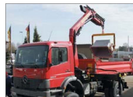
Basculer du bac à sel pour vider le contenu
