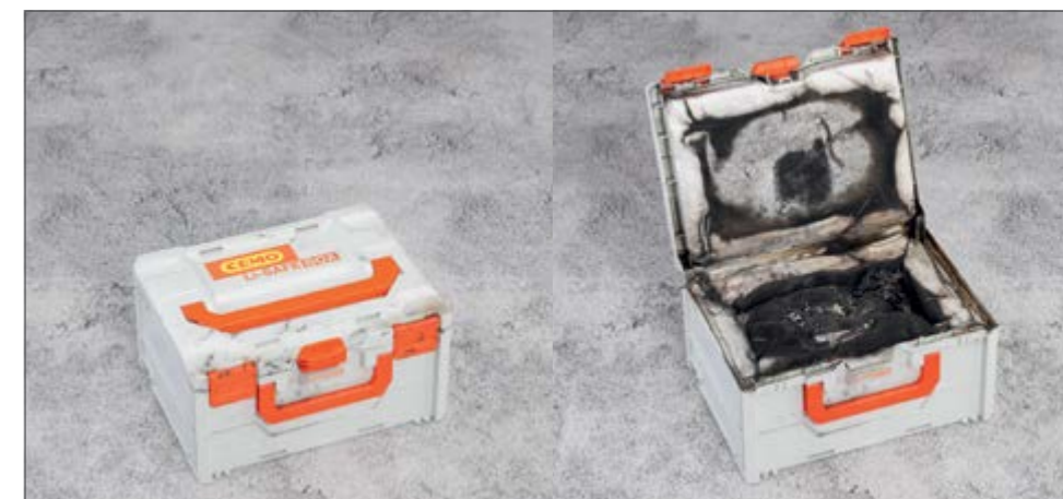
Test de résistance à l'emballage thermique d'une batterie Lithium
