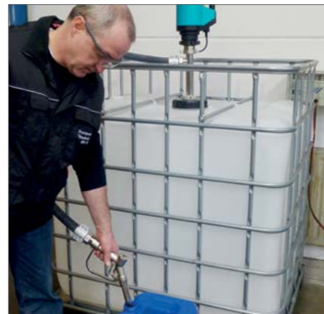
Pompe ATEX, pour solvants et liquides inflammables
