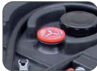
Soupape de surpression et d'aération
