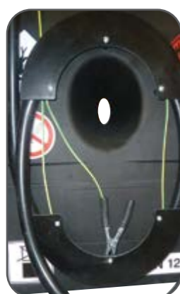
Paroi anti-roulis et système de rangement du flexible
