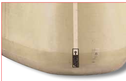
Témoin optique de fuite intégré dans la paroi de la cuve (système breveté) Classe de sécurité 3 selon norme NF EN 13160
